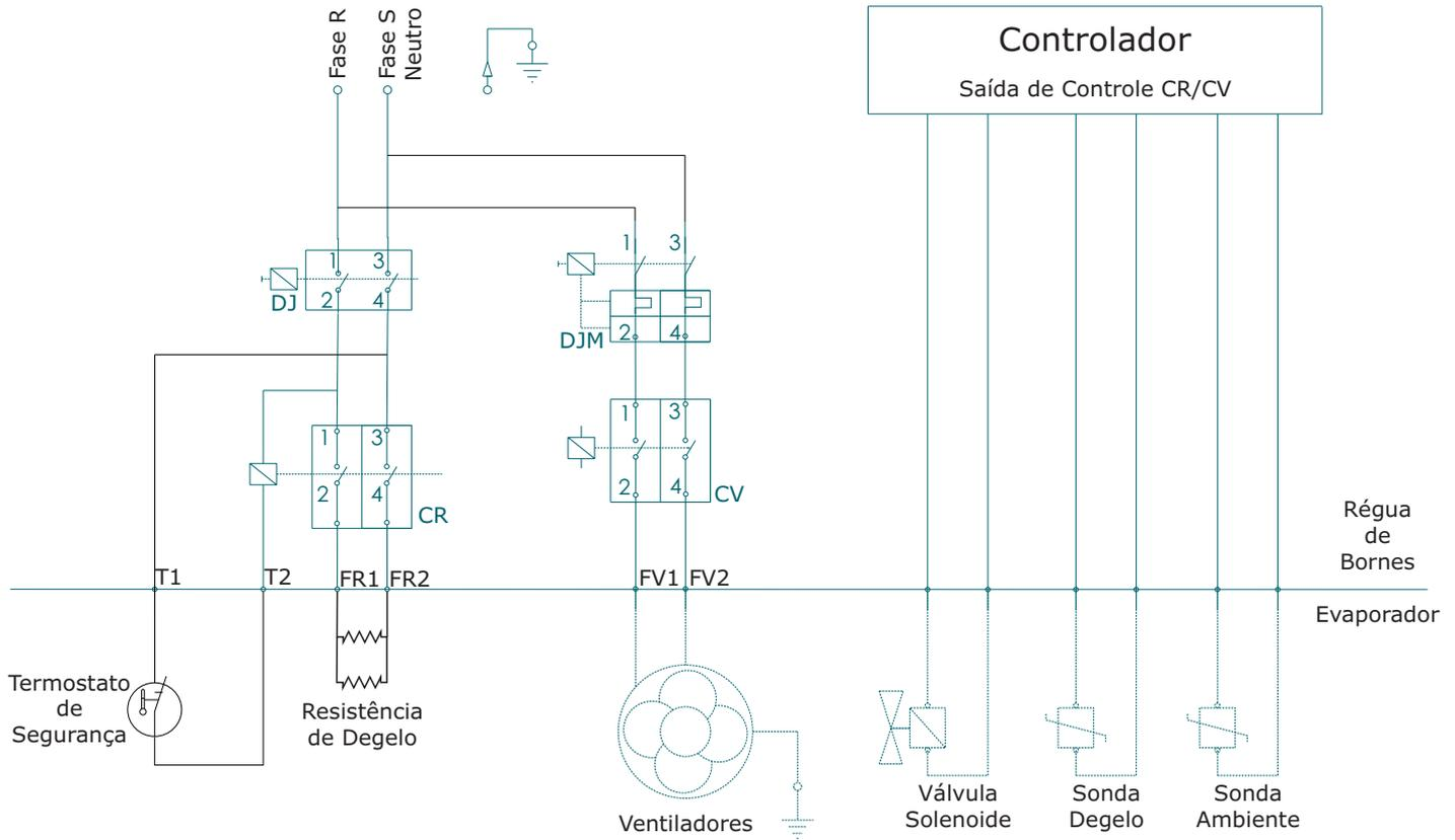
**Degelo 3F 220V 50/60Hz • Ventilador 1F 220V 50/60Hz (3 a 8 motoventiladores)**
